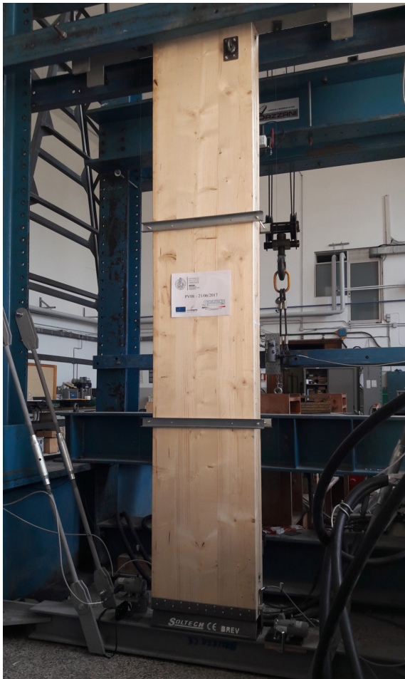
Prove a compressione e instabilità.
